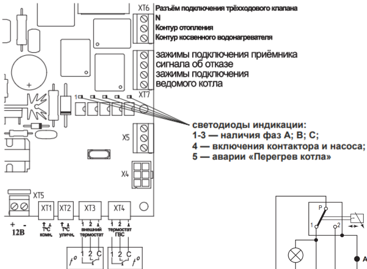
Рис. 1 Схема коммутационной платы котла STOUT.
